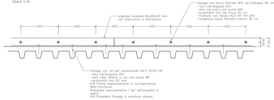
PARTICOLARE 3 - SOLIDARIZZAZIONE SOLAIO SOTTOTETTO IN LAMIERA E MURATURE PERIMETRALI - FISSAGGIO TIPICO CON ANGOLARE PARALLELO ALLE NERVAURE
