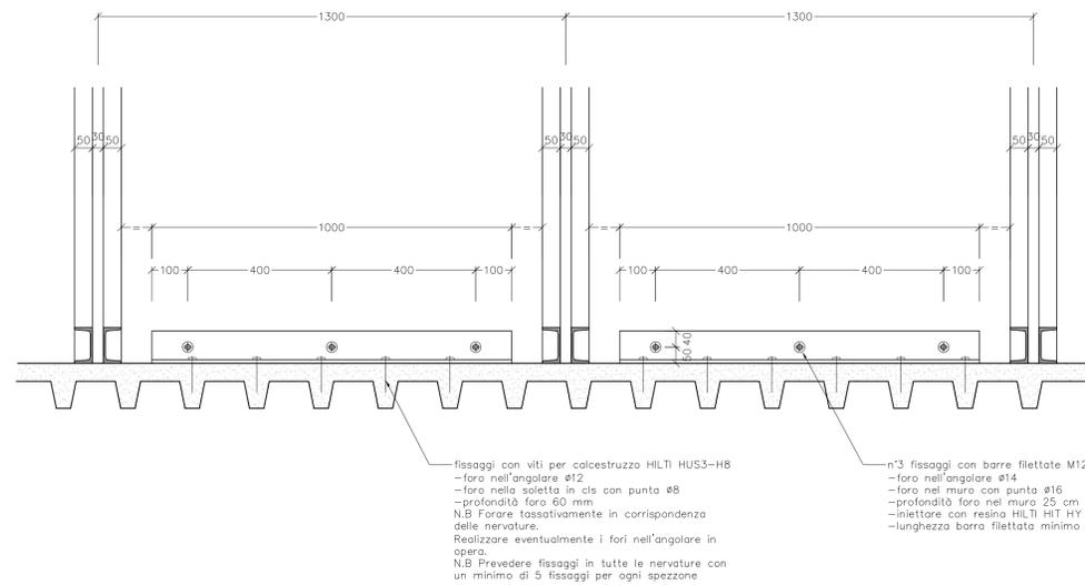
PARTICOLARE 2 - SOLIDARIZZAZIONE SOLAIO SOTTOTETTO IN LAMIERA E MURATURE PERIMETRALI FISSAGGIO TIPICO CON ANGOLARE PERPENDICOLARE ALLE NERVAURE
