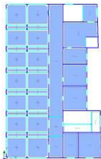
Pianta secondo orizzontamento sopra piano ammezzato: in celeste i solai considerati infinitamente rigidi, in azzurro chiaro quelli considerati deformabili
