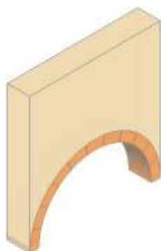
Modellazione architettonica: arco suddiviso in conci (blocchi architettonici)
