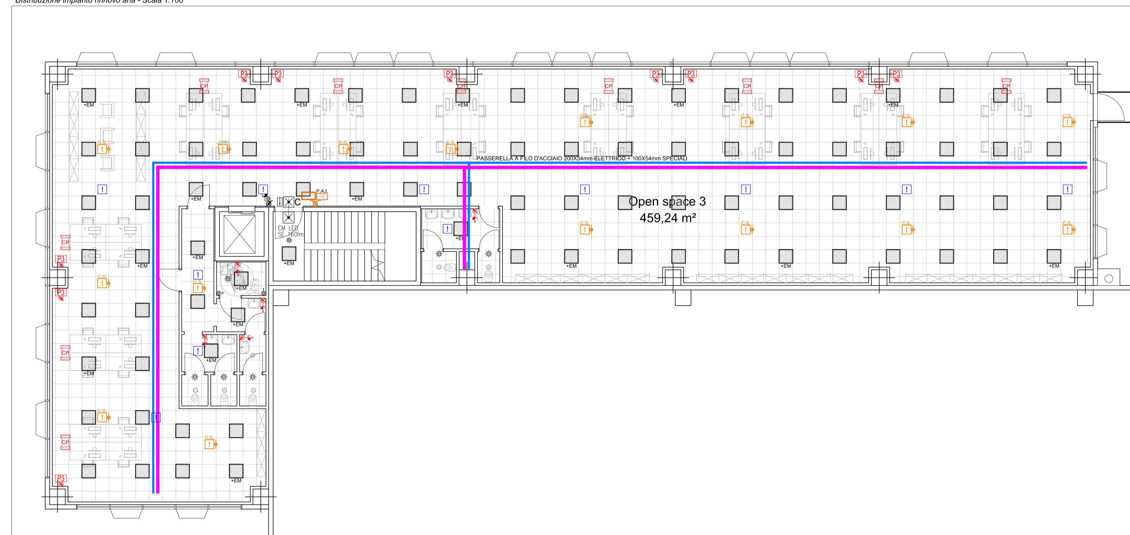
PLANIMETRIA UFFICI PIANO PRIMO: Distribuzione impianto rinnovo aria - Scala 1:100
