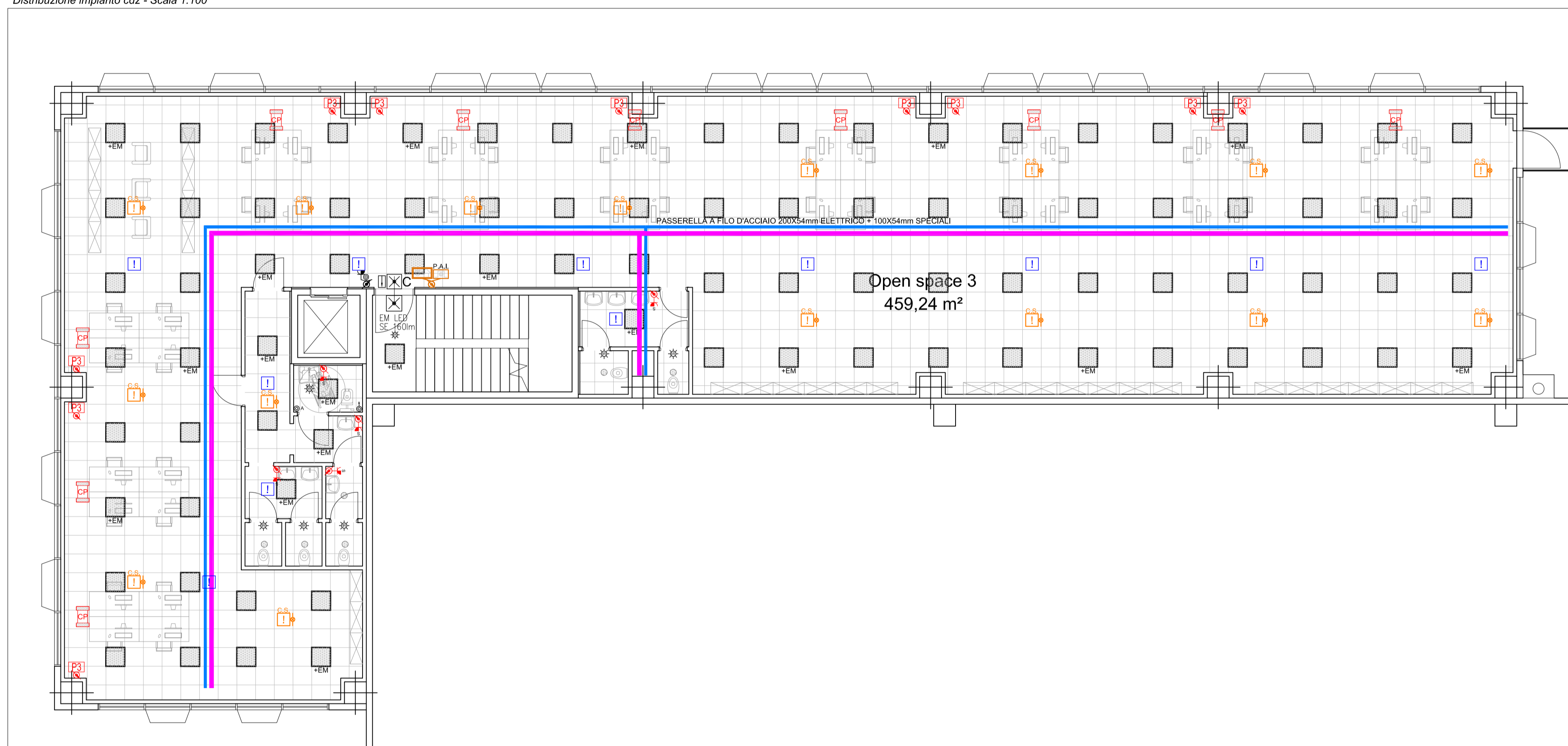
PLANIMETRIA UFFICI COPERTURA: Distribuzione impianti meccanici - Scala 1:100
