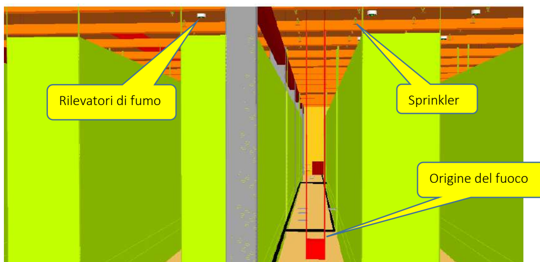
Sezione tridimensionale – Impianti di protezione attiva
