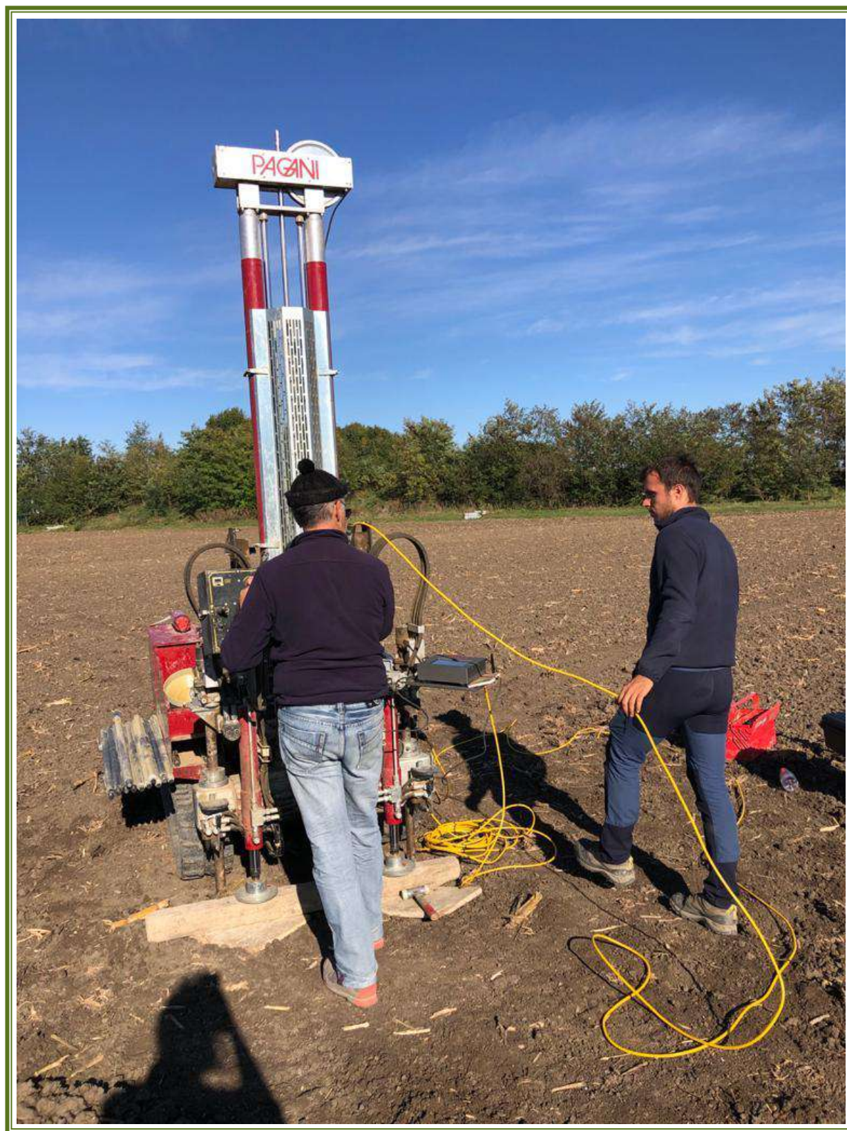
Penetrometro Pagani TG-63200. Configurazione statica per esecuzione prova CPTU6
