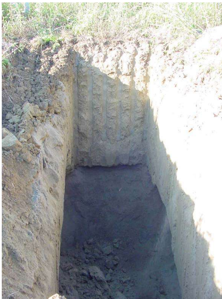
Foto n°41: Particolare dello spessore di coperture ricoprente le sabbie e ghiaie
