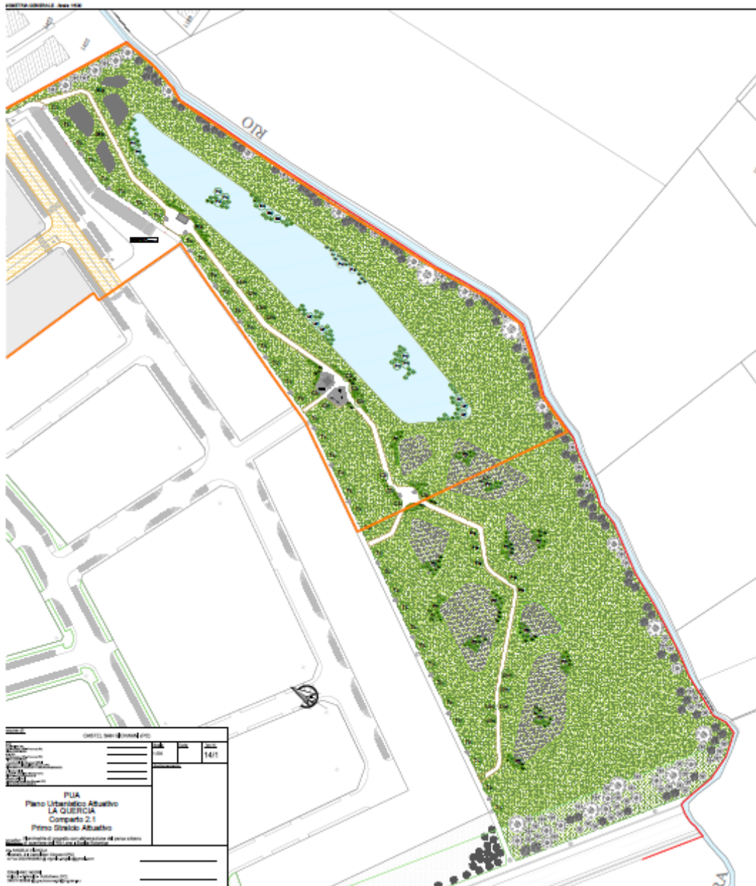
Figura 5 - Posizionamento vasca di laminazione all'interno del Parco Urbano del Rio Lora in progetto.
